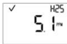
Gasüberwachungsanzeige (numerische Anzeige)
