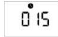
Countdown-Bildschirm Nur für qualifiziertes Personal: Drücken und halten Sie während des 15-sekündigen Countdowns beide Tasten drei Sekunden lang, um den Konfigurationsmodus zu öffnen (siehe „Konfiguration“).
