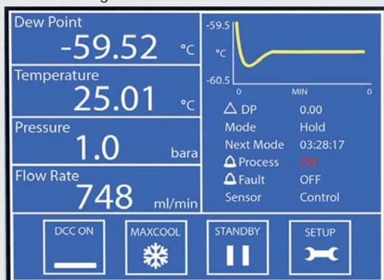
Zwei frei konfigurierbare, potentialfreie Alarmkontakte erlauben den Einsatz des S8000 Integrale Taupunktspiegel Hygrometers zur direkten Prozessregelung. Der kontraststarke LCD Touch-Screen bietet freie Auswahl bei der Anzeige der Messgrößen, einer Trendgrafik und Statusmeldungen.
