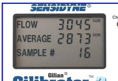
Aus der dazu benötigten, über zwei Infrarotsensoren automatisch ermittelten Zeit wird vom Mikroprozessor der Durchfluss errechnet und auf einem großen, gut ablesbaren LCD-Display digital angezeigt. Eine automatische Mittelwertbildung mit der Möglichkeit des Löschsens von Ausreißern ist integ-
